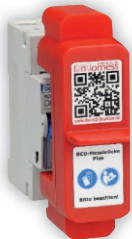
Richtige Positionierung der RCD-Messbrücke
